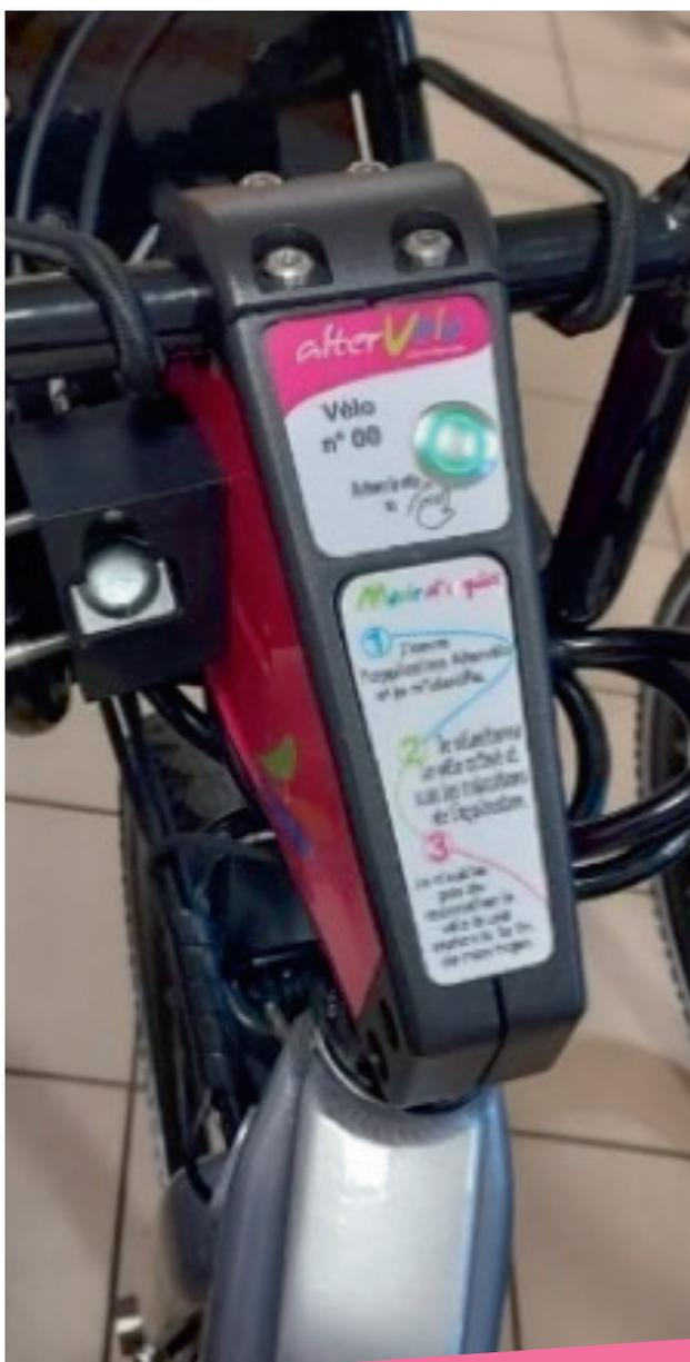
La potence est un boîtier électronique encastré dans le guidon qui présente un bouton permettant une activation du vélo en vue de son utilisation.
